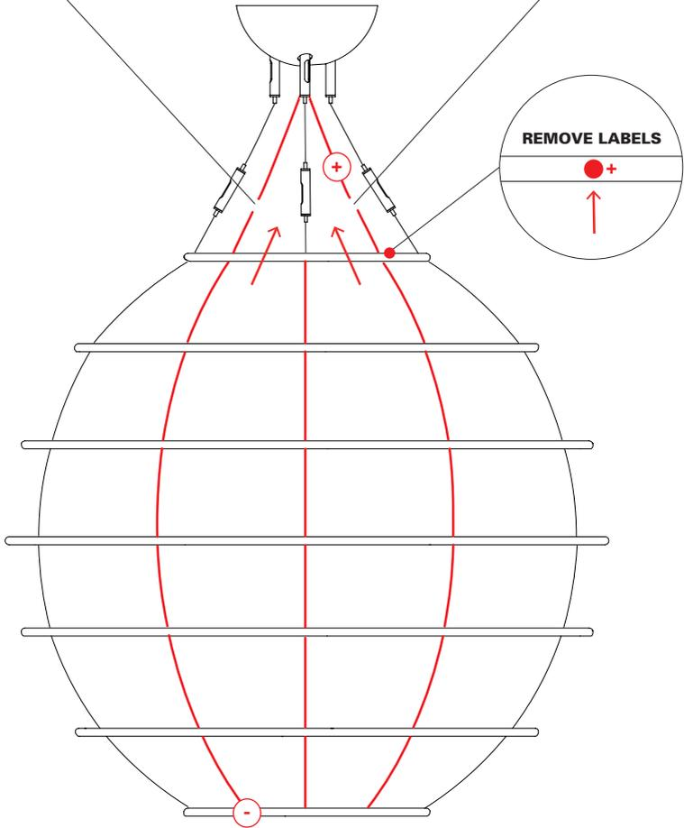
Prima di montare le cover per LED, collegare la lampada e controllare che tutti i LED funzionino correttamente.
