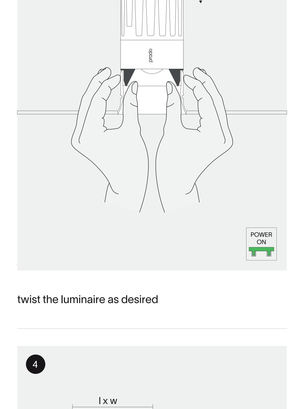
Ix w incl. driver min. 120mm\* max. 30mm
